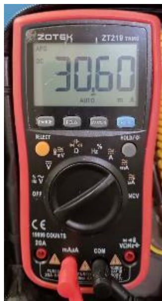
Рисунок 3.1. – Результати заміру струму через світлодіоди
