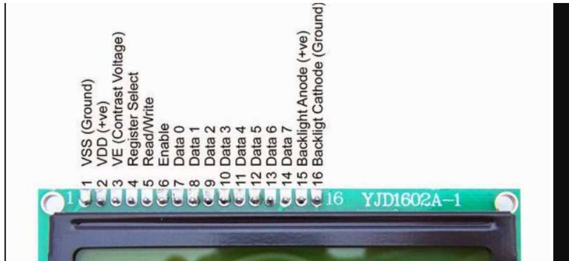
Рисунок 2.9 – Короткий опис пінов LCD 2004
